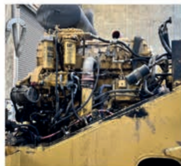
Pro stroje pracující v dole je typické zanesení uhelným prachem
