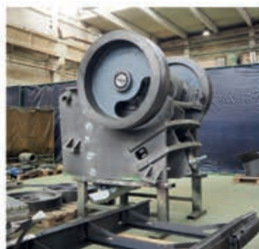
Detail mechanismu, který zajišťuje drcení kameniva na menší frakce
